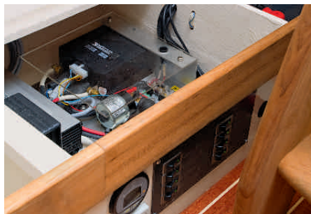
Die kleine Steuereinheit des E-Motors findet neben dem Niedergang Platz
