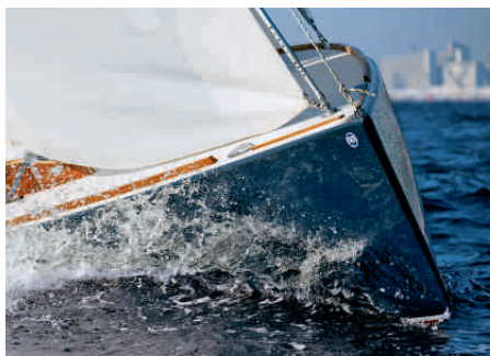
Endlos-Rollanlage für den Gennaker am Bug. Ein Spriet ist nicht vorgesehen
