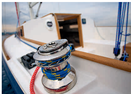
Einzig die Schot läuft über Deck. Fallen und Strecker verstecken sich darunter
