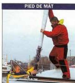
**Simpel und effektiv.** Der Mastfuß ist eine zylindrische Buchse, die bis zum Bootsboden reicht und mit Ihren Teflonlagern den Mast leicht drehen lässt, wenn das Segel nicht zu sehr dicht geholt ist.
