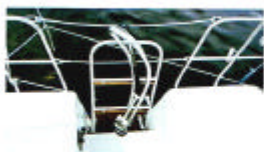
CAFÉ 27 Der kleine offene Heckdurchstieg wird durch die Bäderleiter geschlossen
