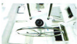
HUNTER Das Steuerad ist zu klein. Wer in Luv steuern will, muss dabei stehen
